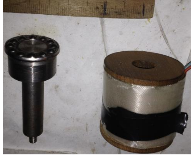
Рисунок – 2.12. Электромагнитные катушки установки и исследуемые образцы
