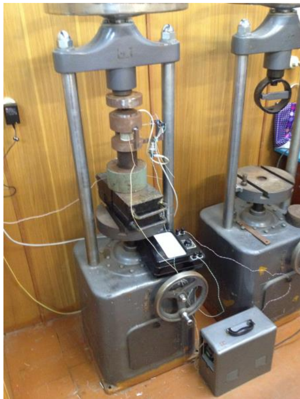
Рисунок – 2.17. Пресс, используемый в качестве установки для создания силы давления на образец
